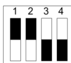
Рис. 21 – Положение переключателей при первом подключении к IP-сети
