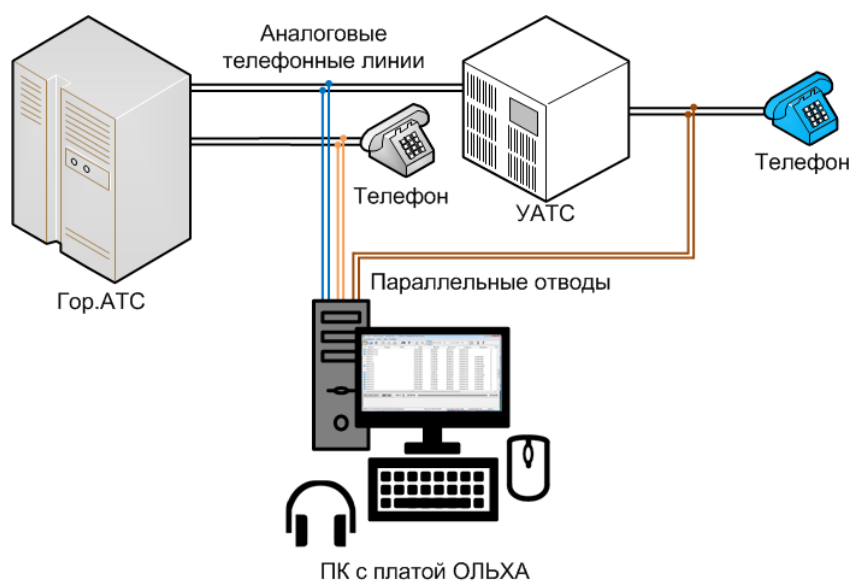
Рис. 57 Схема подключения параллельных отводов телефонных линий
